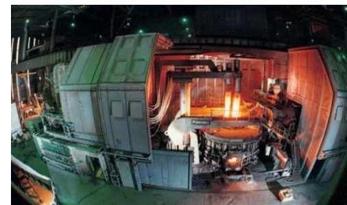
Enceinte de confinement du four à arcs électriques (doghouse)
