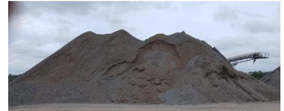
Scalpage pour retrait des argiles / stériles (0/31.5mm)
