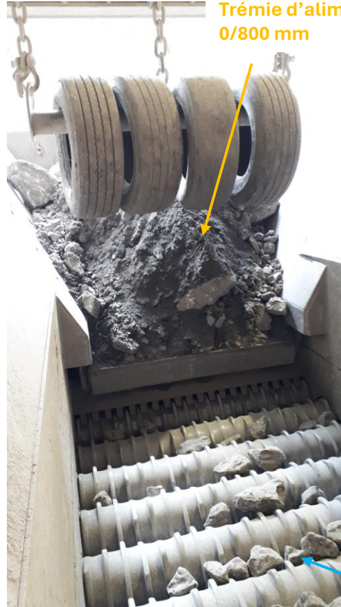
Scalpage pour retrait des argiles / stériles (0/31.5mm)
